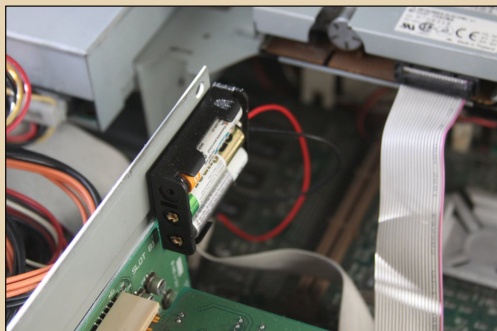
Рис 4. Неразборная батарейка PRAM-памяти Rayovac 840 давно села и заменена на «аналог» из 3 батареек AAA
