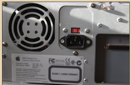
Рис 2. На блоке питания можно сэкономить, если вольтаж выставлять вручную
